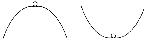
图 10 四极杆滤质器的“电势阱”
